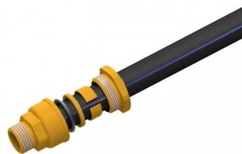
Das Rohr und die Komponenten im Körper des Anschlussteils positionieren und das System manuell durch Zudrehen der Mutter verschrauben. Die Mutter mit einem Schraubenschlüssel oder einem geeigneten Werkzeug mit einem Anzugsmoment anziehen wie es in der Tabelle angezeigt ist [siehe vorhergehende Seite].
