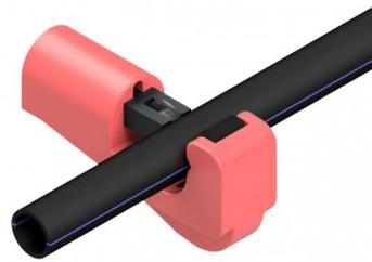
Insérez les éléments sur le tube dans l'ordre suivant : écrou, ogive coupée (les repères sur la surface extérieure doivent être orientés vers l'écrou), bague de compression et joint (et enfin la douille si elle est prévue)
