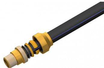
Positionnez le tube et les composants dans le corps du raccord en serrant manuellement le système de vissage de l'écrou. Serrez l'écrou avec une clé fixe ou un outil approprié, en appliquant un couple de serrage comme dans le tableau [page précédente].
