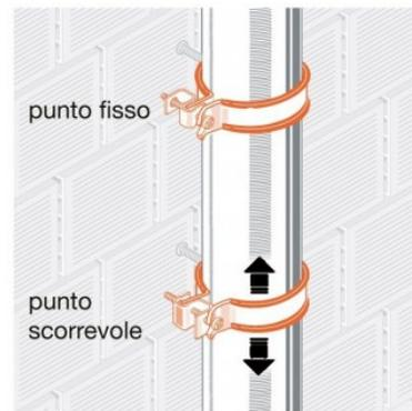
En largos trechos de tubería recta, para absorber posibles variaciones en el largo, se aconseja insertar al menos una curva de expansión cada 10m de tubo, como se muestra en el siguiente esquema. Para tuberías de diámetro igual o superior a 32 mm, las curvas de expansión son obligatorias.
