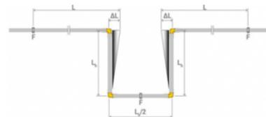
El largo mínimo del brazo de expansión ( $L_b$ ) se puede calcular utilizando la fórmula  $L_b = C \times \sqrt{\varnothing \times \Delta L}$
