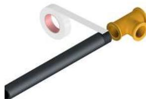
Verificar que no se haya colocado material de manera excesiva para prevenir posibles rupturas causadas por un apriete excesivo.
