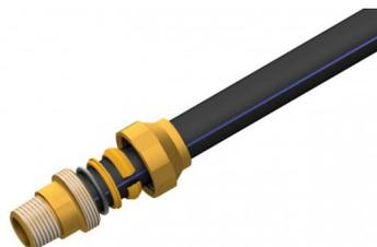
Posizionare il tubo e i componenti nel corpo raccordo bloccando manualmente il sistema con l'avvitamento del dado. Serrare il dado con chiave fissa o attrezzatura idonea imprimendo una coppia di avvitamento come in tabella [pag. precedente].
