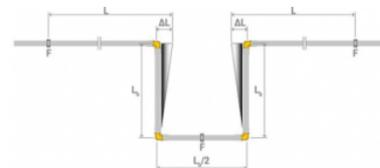
Die Mindestlänge des Biegeschenkels ( $L_b$ ) kann mit folgender Formel berechnet werden  $L_b = C \times \sqrt{\varnothing \times \Delta L}$
